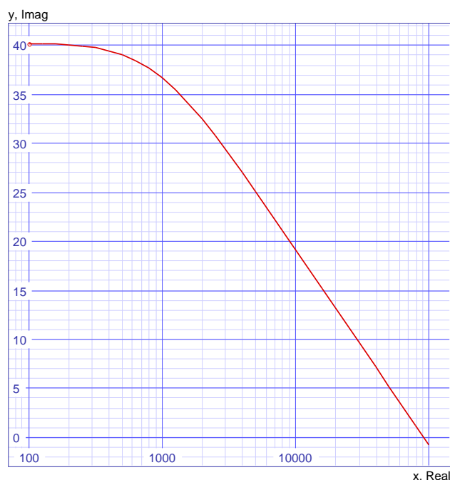
Slika 2: Ojačenje operacijskega ojačevalnika (v dB ) z obremenjenim izhodom ( 32\Omega ) v odvisnosti od frekvence
