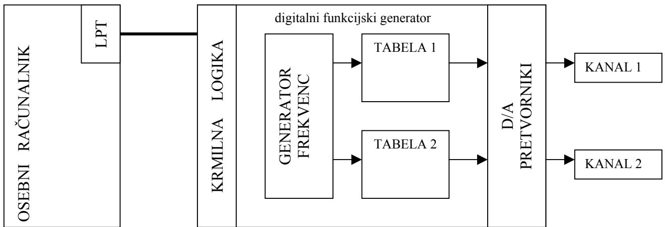
**Osebni računalnik** skrbi za prenos podatkov od uporabnika do digitalnega funkcijskega generatorja-DFG na čim bolj preprost in enostaven način za uporabnika.
