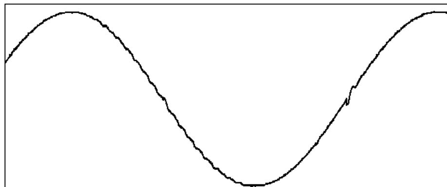
Vsi signali so enake amplitude. A pri veliki frekvenci, se pojavijo rahle oscilacije.
