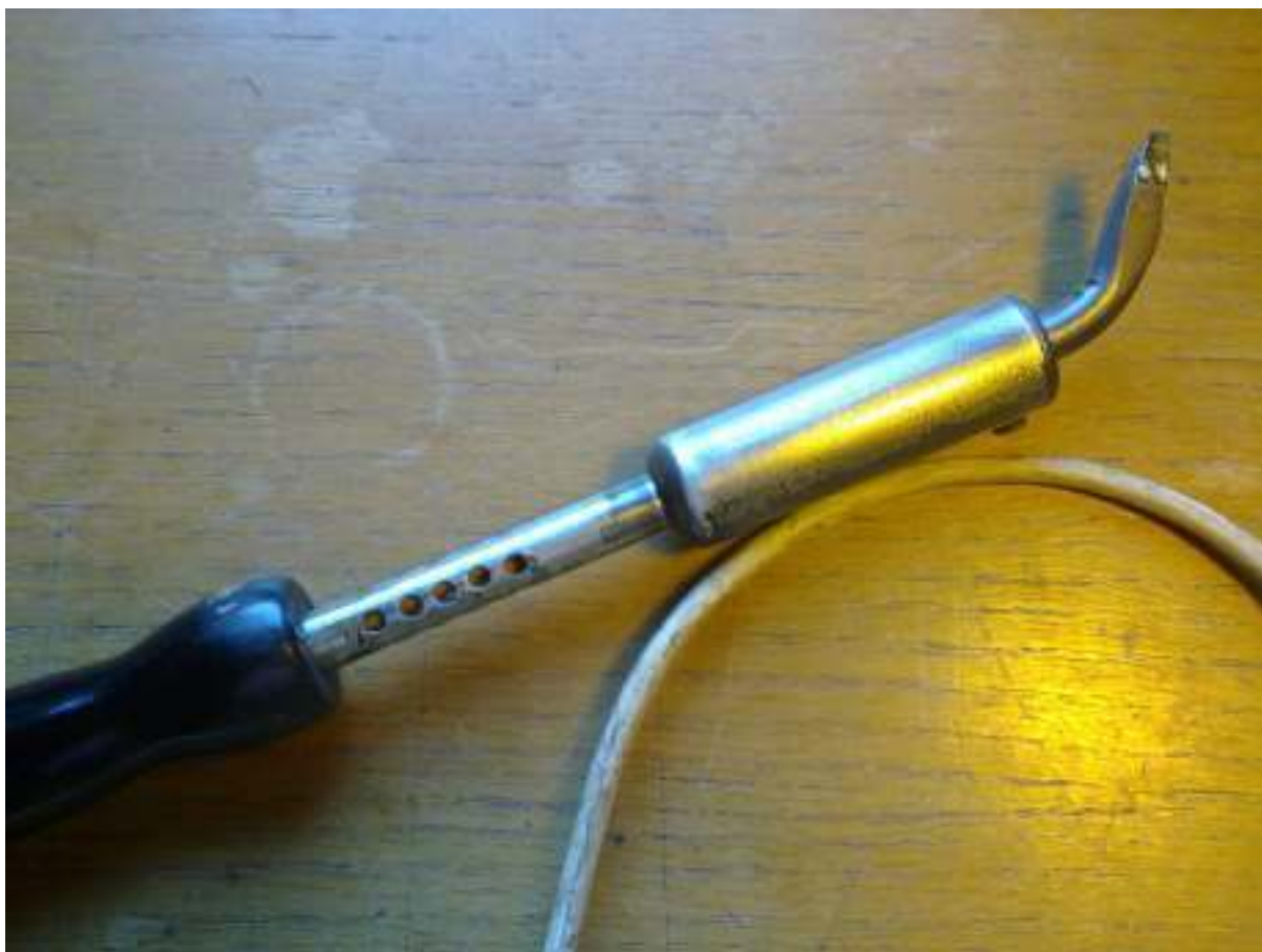
Starejši 150W »spenglerski« spajkalnik, produkt Jugoslavije. Izkazal se je kot zelo uporaben pri pospajkavanju vezij.
