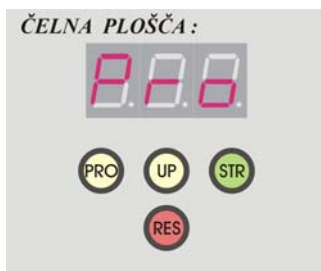
SLIKA 4: Pogled na čelno ploščo ob priklopu napetosti
