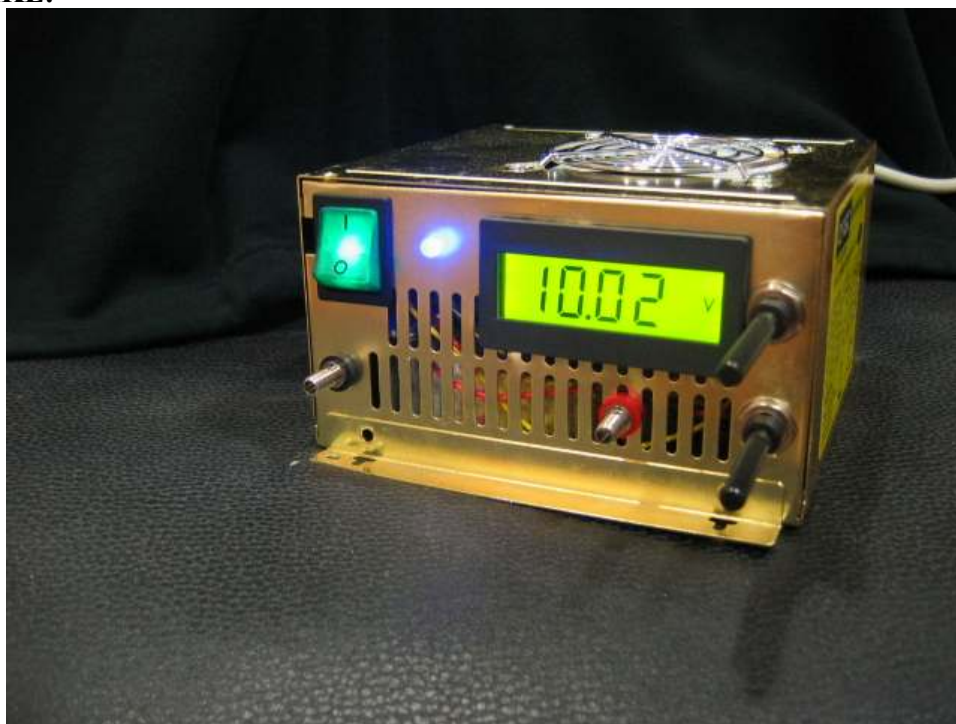
Prednja plošča z voltmetrom in stikali.
