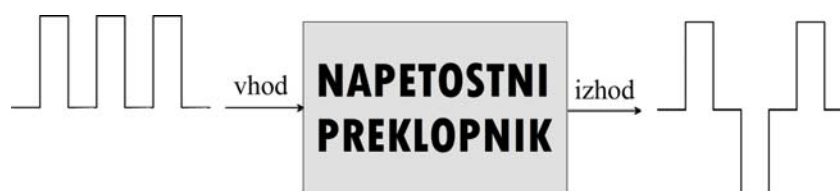
Slika 1.3 Simboličen prikaz zamenjave polaritete vhodnega signala
