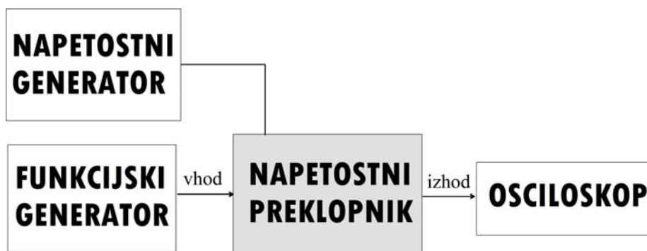
Slika 2.5 Simboličen prikaz vezave preizkusa napetostnega preklopnika.
