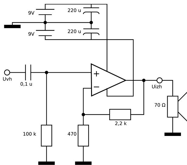
V glavnem delu vezja je operacijski ojačevalnik vezan v vezavi za neinvertirajoče ojačanje. Napetostno ojačenje izračunamo po formuli  $A_u = 1 + R_1/R_2$ , kjer je  $R_1$  upor med izhodom in invertirajočim vhodom O.O.,  $R_2$  pa upor med invertirajočim vhodom in maso. Tako izračunano ojačenje znaša 5,7 ali 15 dB.
