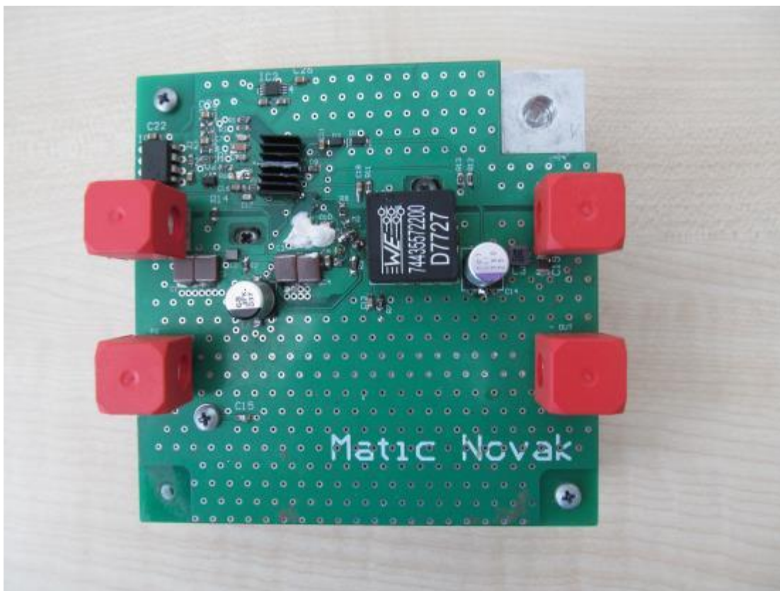
Slika 2: Močnostni pretvornik navzdol študent: Matic Novak
