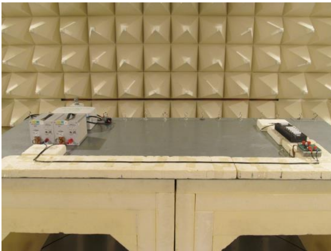
Slika 31: Merilna postavitve za merjenje sevalnih emisij v pol-neodbojni EMC sobi
