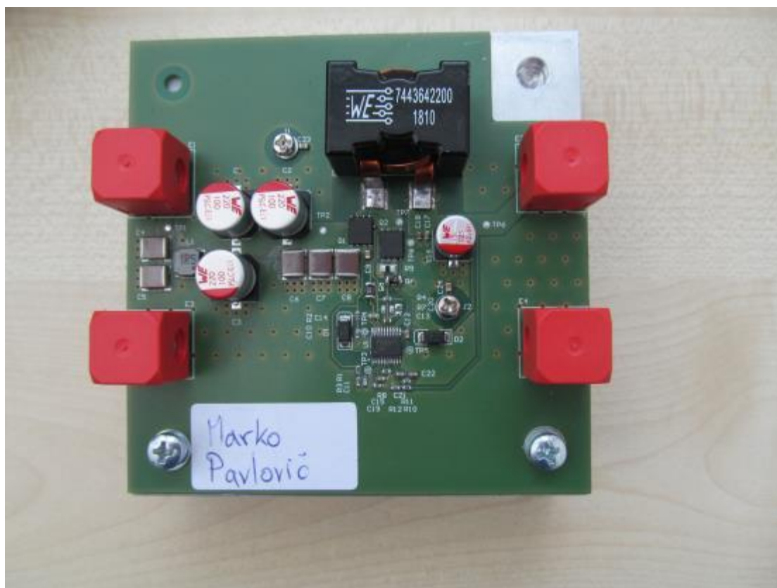
Slika 4: Močnostni pretvornik navzdol študent: Marko Pavlovič
