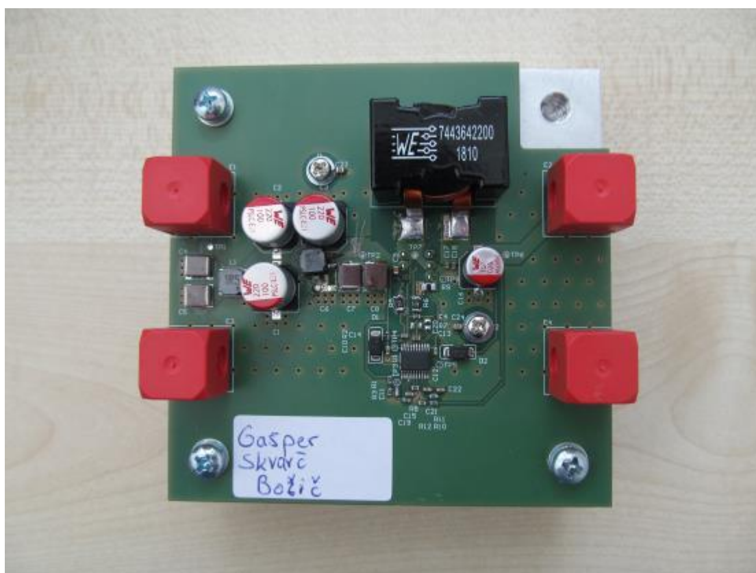
Slika 7: Močnostni pretvornik navzdol študent: Gašper Skvarč Božič
