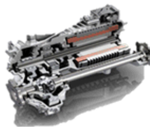
Motorji za vgradnjo v pogonsko os
